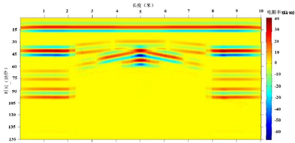
图 B-6 低介低导污染模型的探地雷达正演结果
