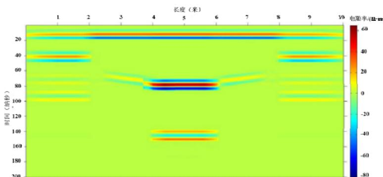
图 B-9 高介高导污染模型的探地雷达正演结果
