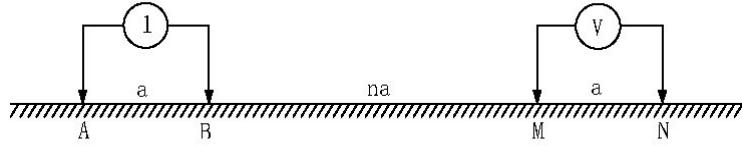
图 D-7 偶极装置法示意图
