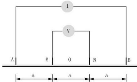
图 D-4 温纳装置示意图
