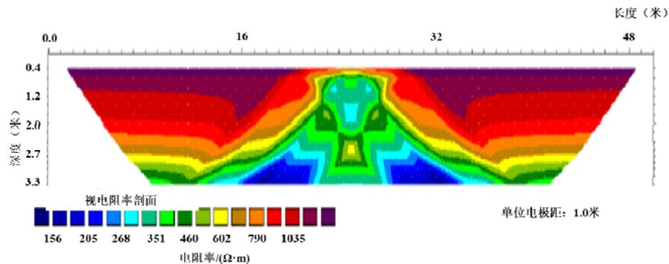
图 B-7 高介高导污染模型的正演结果(偶极-偶极)
