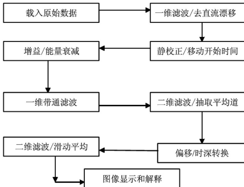
图 5-1 探地雷达测量数据处理流程
