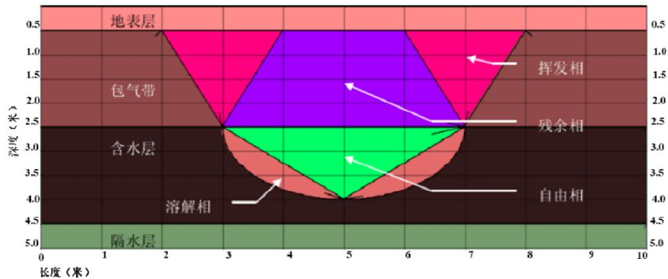
图 B-3 探地雷达法的污染理论模型
